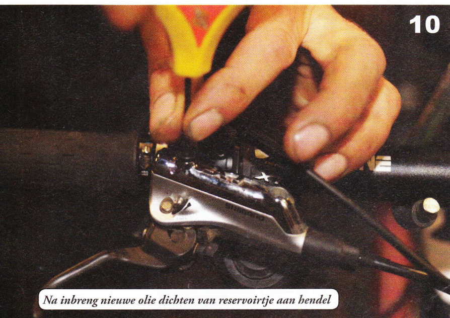
Slangetje aansluiten drukken tot oliepeil in het opvangreservoirtje aan hendel zowat anderhalve cm van de bovenrand komt
