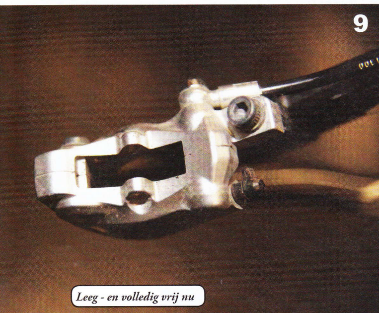
Met een speciale tool of met een plasticen bandafnemer de pistons terugdrijven - mooi gelijk aan de kanten
