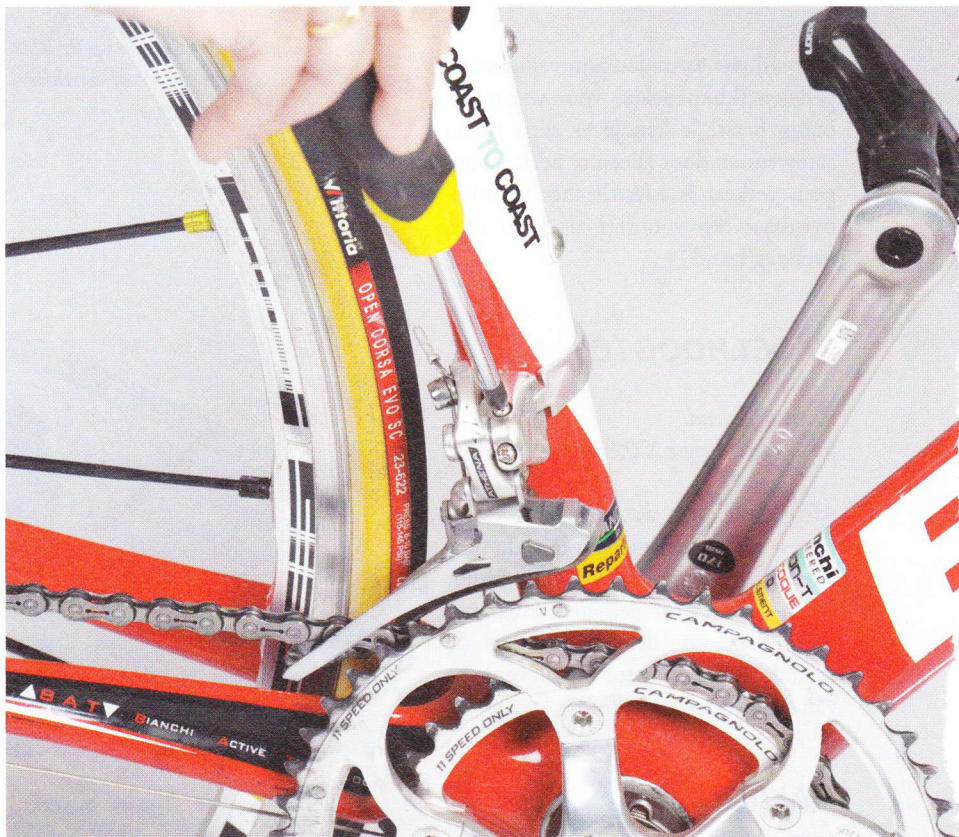
Voorderailleur. De kettinggeleider (vork) loopt perfect parallel met de tandwielbladen en komt 2 tot 3 mm boven de tanden van het grootste blad. Bereik afstellen: met kruisschroevendraaier via stelschroef L (zie foto) en H.
