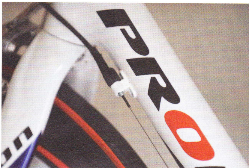
Fijn afstellen via kabels aan het frame
