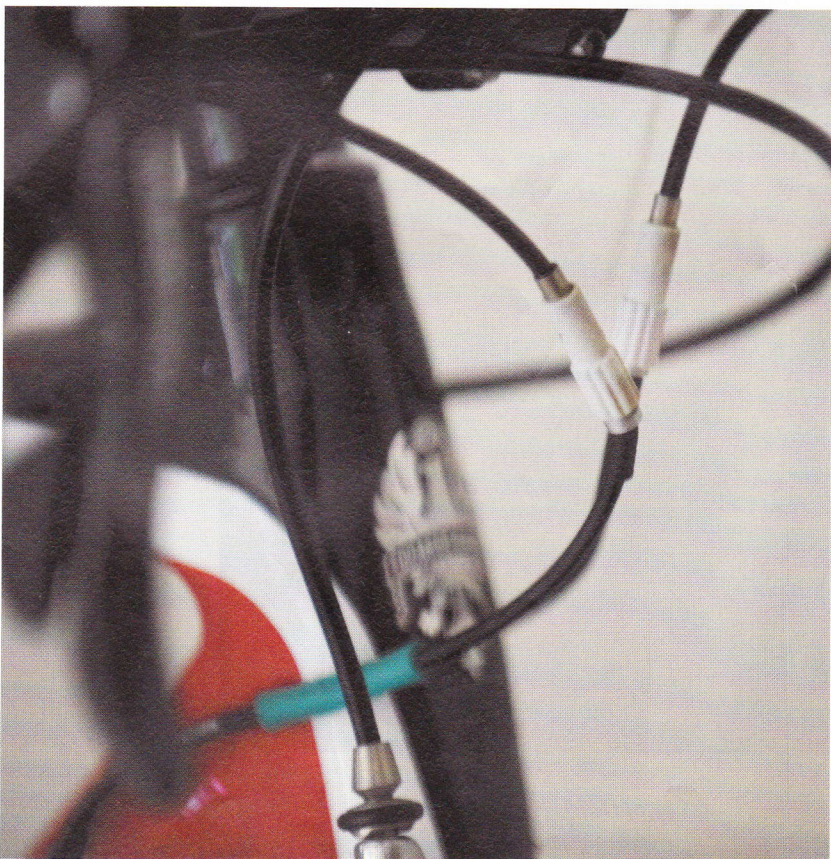
Fijn afstellen binnen de kabels
