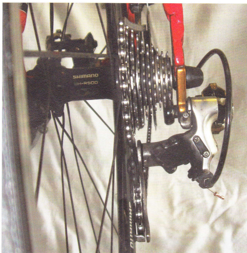
Grootste cassettekroontje en bovenste derailleurwiel-tjes precies over elkaar
